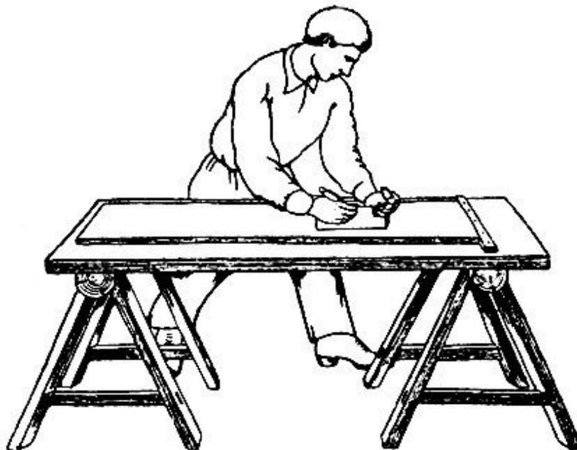
*Рис. 20. Устройство заменяющее верстак*
