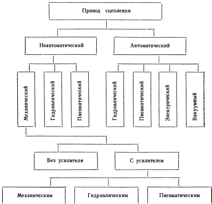
Фиг. 3. Классификация приводов автомобильного сцепления.
