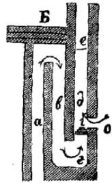
Проведеніе дыма въ дымовую трубу: рис. 39—во вьюшку; рис. 40—подъ вьюшку; *a*, *e*, *i*, *д*—дымоходы; *i*—вьюшка; *e*—вторая вьюшка; *с*—трубное отверстіе.
