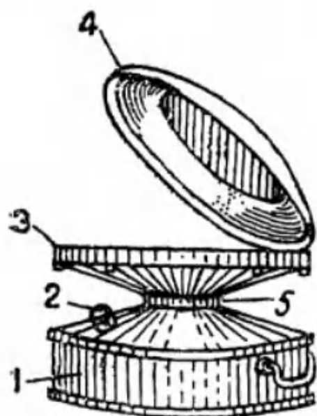
Рис. 19. Каталитическая печь «Апир» (общий вид). 1 — резервуар; 2 — заливное отверстие; 3 — каталитическая горелка; 4 — крышка для тушения печи; 5 — горловина
