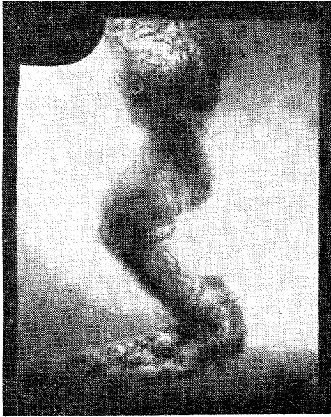
Рис. IV.44. Вихреобразное течение жидкости за рабочим колесом радиально-осевой турбины при разных режимах работы
