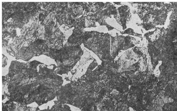
Фиг. 25. Микроструктура обработанных зубчатых колес из стали 40X.
