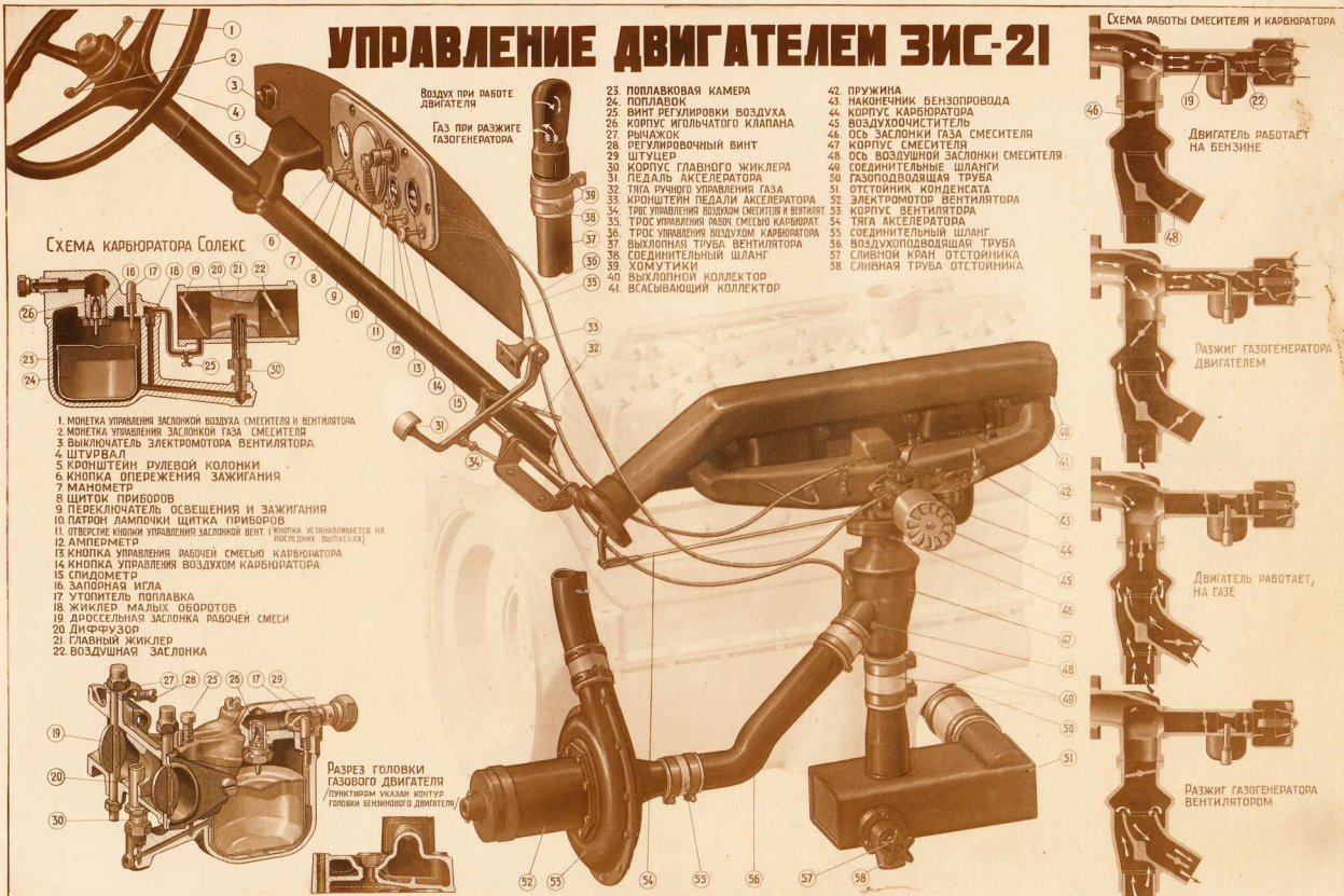
СХЕМА РАБОТЫ СМЕСИТЕЛЯ И КАРБЮРАТОРА
