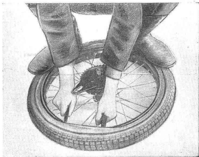
Рис. 31. Снятие покрышки с колеса.
