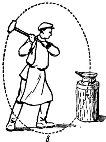
К у в а л д а — большой молоток весом от 2 до 10 кг. Он служит для нанесения сильных рабочих ударов обеими руками при ковке, сварке, рубке и прочих кузнечных операциях. Кувалды изготовляют из углеродистой инструментальной стали марки У7.
