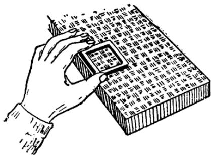
Рис. 185. Проверка точности шабровки.
