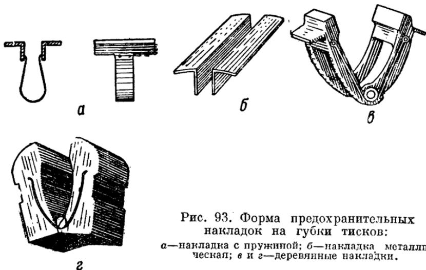
Рис. 93. Форма предохранительных накладок на губки тисков:
