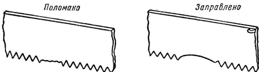
Рис. 127. Заправка ножовочного полотна при поломках нескольких зубьев.
