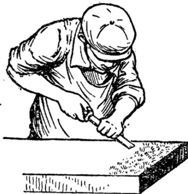
Рис. 184. Положение шабера и работающего при шабровке.
