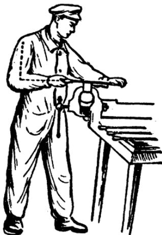
Рис. 136. Правильное положение корпуса и постановка ног при опилковке металла в тисках.
