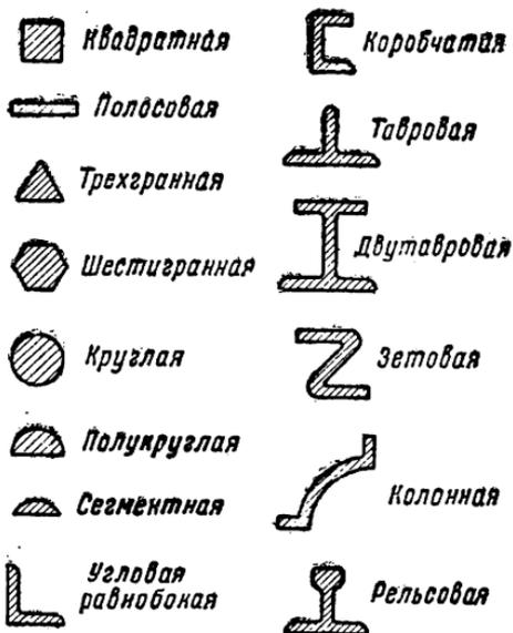
Рис. 8. Различные профили стали, получаемые прокаткой.
