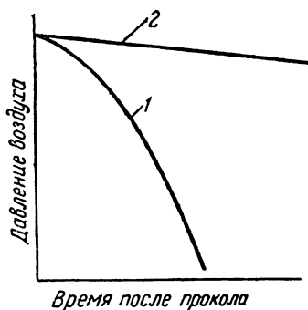
Рис. 14. Падение давления воздуха в камерной и бескамерной шинах после прокола: 1 — камерная шина; 2 — бескамерная шина.
