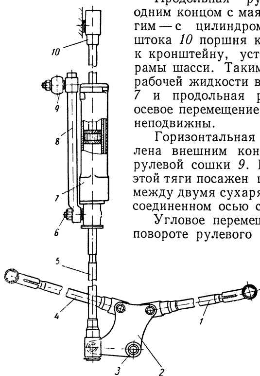
Фиг. 47. Схема привода рулевого управления автопогрузчиков 4000М, 4003, 4006 и 4009 с включенным гидравлическим усилителем:
