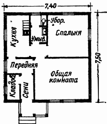
Рис. 2. Двухкомнатный жилой дом (с центральным отоплением).
