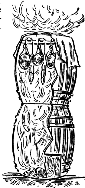
Рис. 14. Устройство коптильни из двух бочек.
