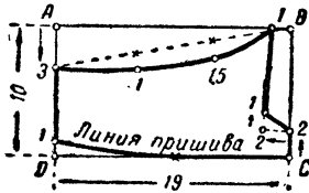
Рис. 44. Чертеж выкройки воротника.
