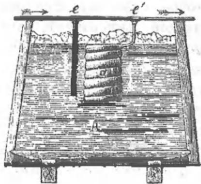
Рис. 50-й. Герметически закрытый охладитель *a* вставленъ въ сусло бродильнаго чана. Холодная (ледяная) вода входитъ въ *e* и, пройдя через охладитель *a*, выходитъ изъ *e'*. Направленіе теченія воды показано стрѣлками.
