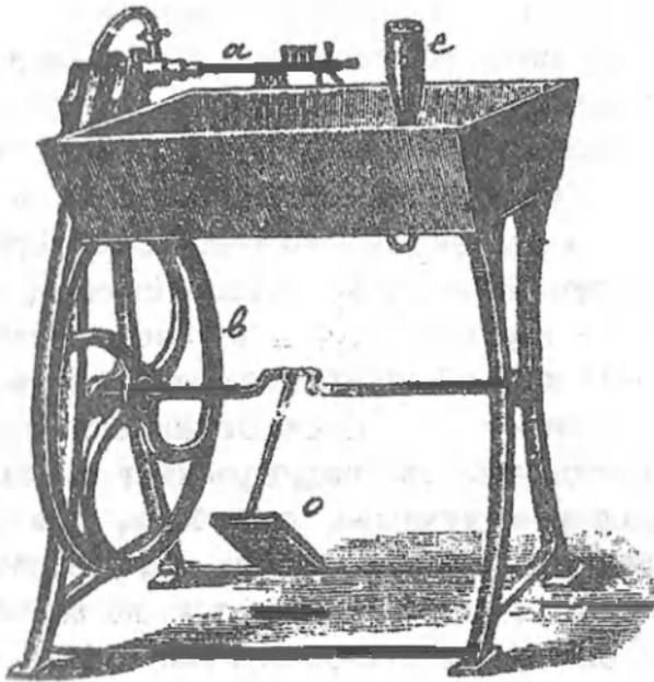
Рис. 57-й. Приборъ для очистки и промыванія бутылокъ.
