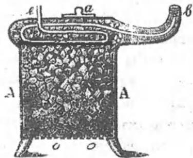
Рис. 53-й. Приборъ для очистки-же отъ старой смолы при помощи горячаго воздуха и перегрѣтаго пара.
