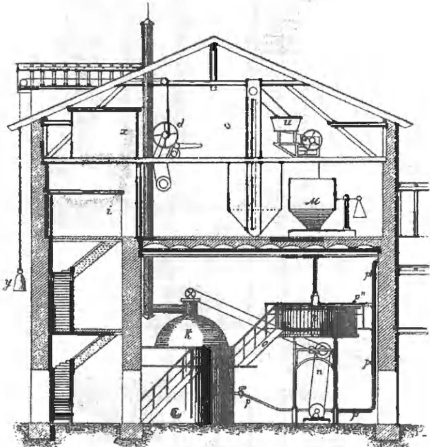
Рис. 23-й. Варочное отдѣленіе той-же пивоварни (*Е* рис. 22-го). Тѣхъ пивоварняхъ, въ которыхъ заторный чанъ помещается ниже котла, сусло изъ него спускается въ находящейся подъ нимъ спускной чанъ и уже изъ послѣдняго переводится въ котель при помощи насоса.
