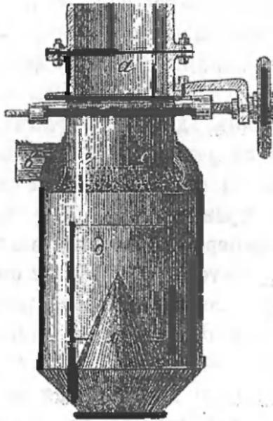
Рис. 33-й. Самодѣйствующій предзаторный аппаратъ.
