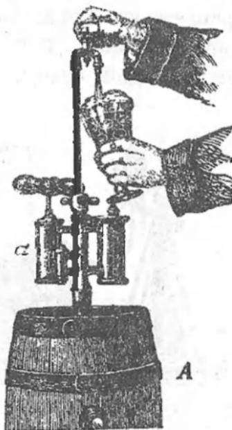
Рис. 61-й. Упрощенный изобарометрический аппарат, годный и для домашняго употребленія: *A*—боченокъ съ пивомъ; *a* — насосъ для накачиванія воздуха въ боченокъ.
