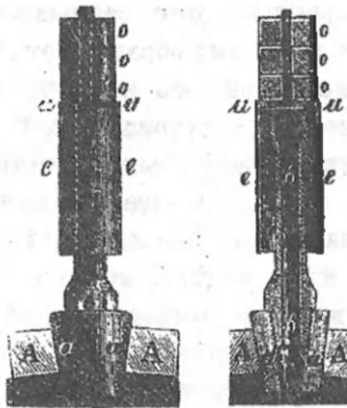
Рис. 65-й. Предохранительный клапанъ *Берша*, ввинченный въ деревянную пробку (*а а*), затыкающую втулку бочки (*А А*). Справа клапанъ представленъ разрезаннымъ продольно — для показанія его внутренности.
