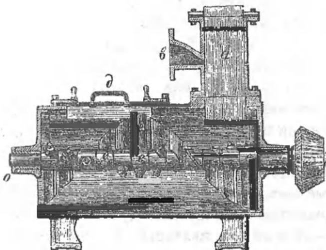
Рис. 34-й. Механическій предзаторный аппаратъ.
