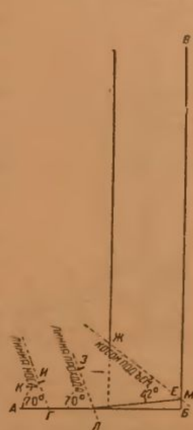
Рис. 44. Вычерчивание модели для вытяжных сапог—вторая стадия работы.
