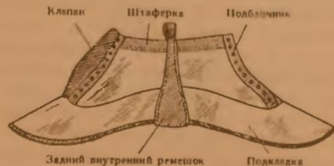
Рис. 56. Подготовка мужских на кривках (внутренняя сторона).
