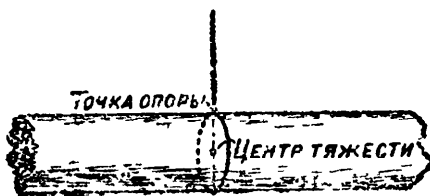
Рис. 33. Палка, подвешенная за середину: положение равновесия.
