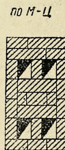
Рис. 57. Кирпичная горизонтальная печь конструкции печной лабораторий быв. Гипросельхоза с двумя параллельными оборотами, соединенных вертикальными оборотами.
