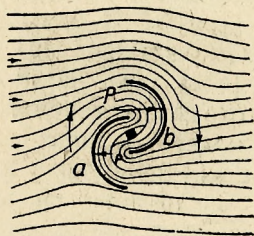
Фиг. 11а. Схема работы роторного ветряка
