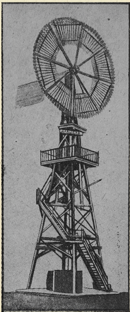
Фиг. VII. Многолопастный ветродвигатель конструкции инж. В. П. Давыдова (1896)
