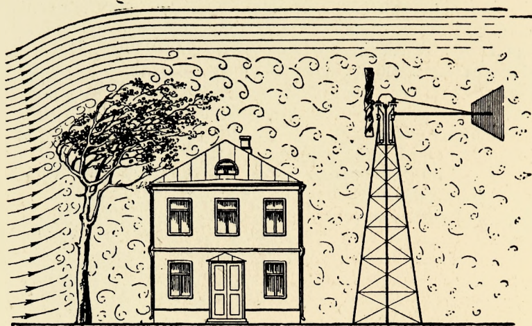
Фиг. 6. Влияние препятствий на направление и скорость ветра
