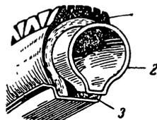
Фиг. 758. Разрез собранной пневматической шины.
