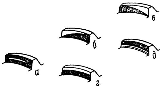
Фиг. 531. Расположение отпечатков на зубьях ведомой шестерни главной передачи при регулировке зацепления шестерён.
