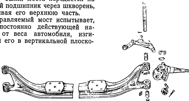
Фиг. 671. Передний мост автомобиля Додж.
