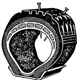
Фиг. 764. Шина с камерой, имеющей ячейки, заполненные пластичной массой.
