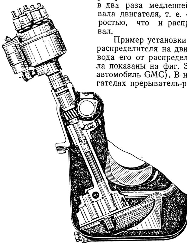
Фиг. 340. Установка прерывателя-распределителя на двигателе.
