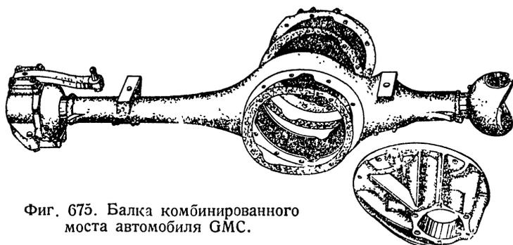
Фиг. 675. Балка комбинированного моста автомобиля ГМС.
