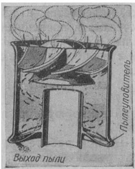
Фиг. 237. Схема инерционного воздухоочистителя.
