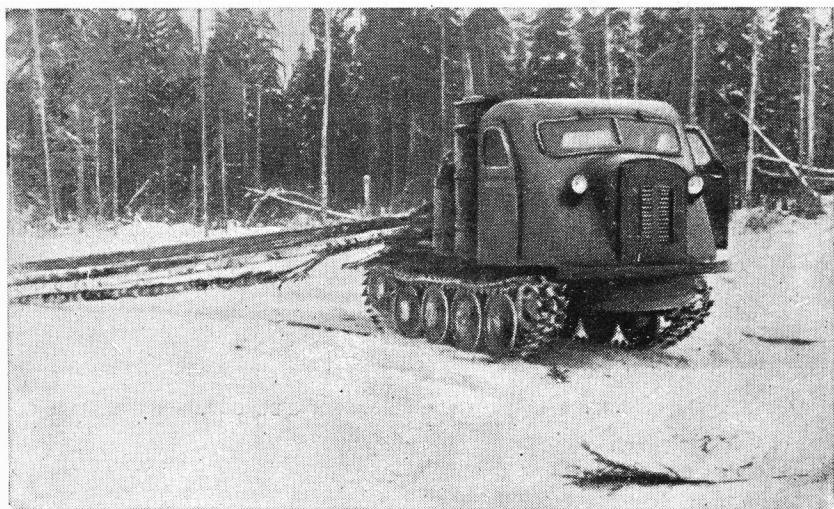
Фиг. 95. Трактор с грузом хлыстов на повороте.
