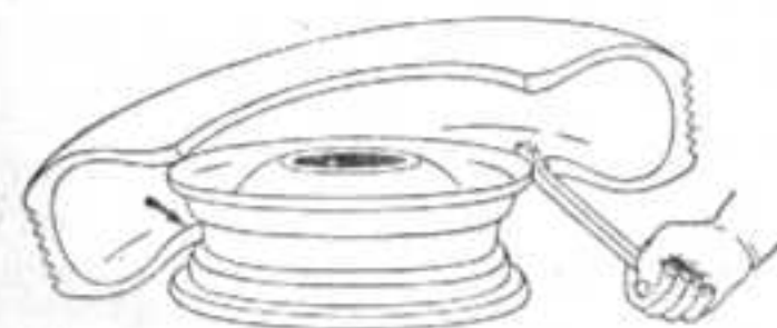
Фиг. 18. Демонтаж покрывки.
