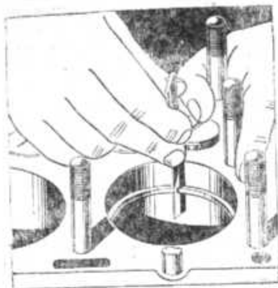
Фиг. 79. Проверка зазора в замках поршневых колец.
