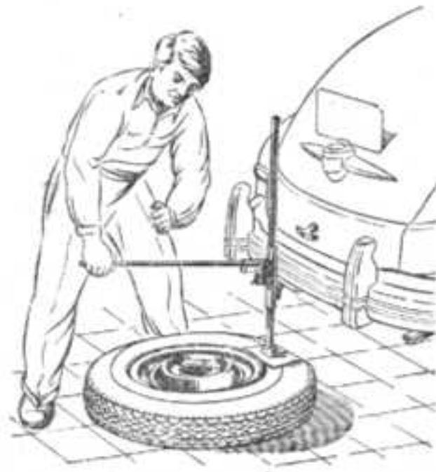
Фиг. 17. Отделение покрывки от обода колеса в случае «прилипания».
