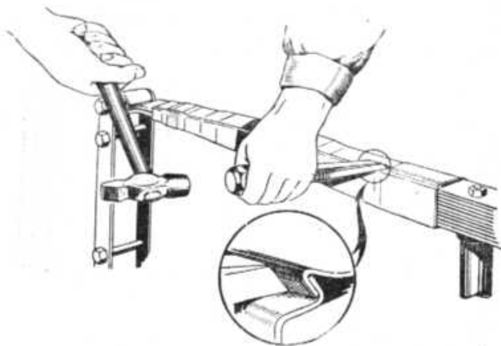
Фиг. 129. Снятие чехлов с рессоры.
