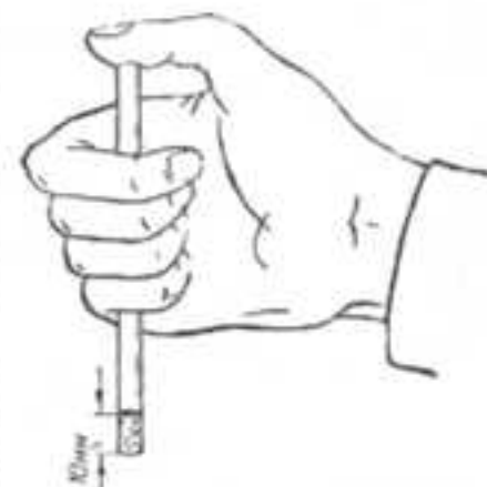
Фиг. 138. Проверка уровня электролита при помощи стеклянной трубки.
