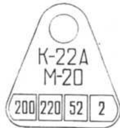
Фиг. 67. Бирка на карбюраторе, характеризующая пропускную способность жиклеров.
