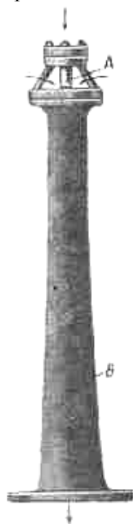
Рис. 324. Пароструйный инжектор типа Мельдрум. A – сопло, B – диффузор.
