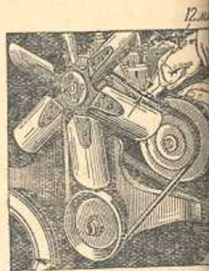
Рис. 26. Регулировка натяжения ремня вентилятора
