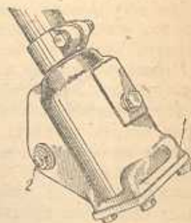
Рис. 39. Регулировка осевого люфта вала рулевой сошки:
