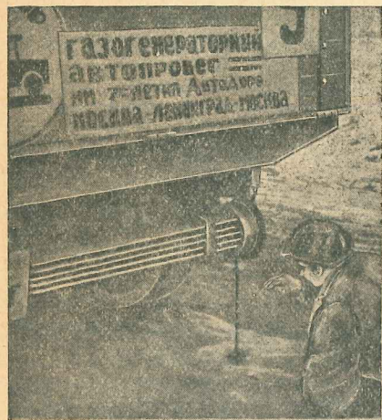
Фиг. 80. Спуск из частей установки выделившейся воды.
