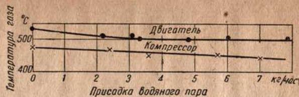
Фиг. 62. Зависимость температуры генераторного газа от присадки водяного пара.
