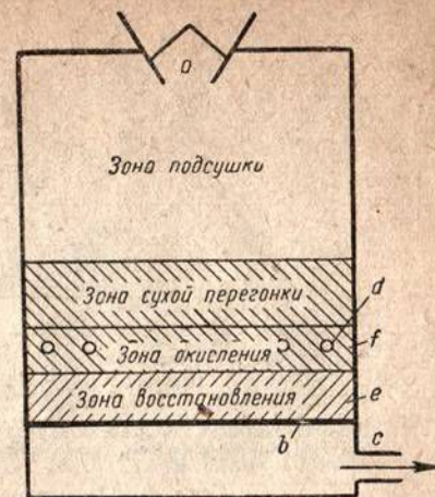
Фиг. 2. Газогенератор с опрокинутым процессом газификации:
