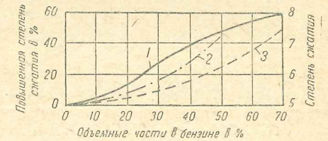
Фиг. 22. Допустимые степени сжатия в зависимости от примеси к бензину спирта (1) и бензола (3) (Каллендар).
