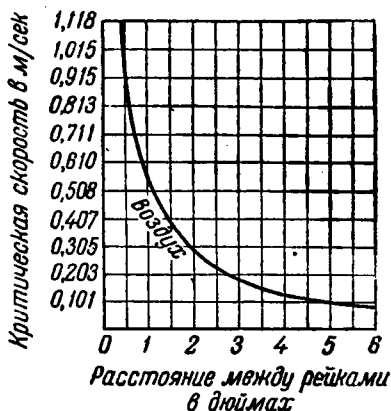
Рис. 16. Значение критических скоростей газа при разном расстоянии между рейками насадки.
