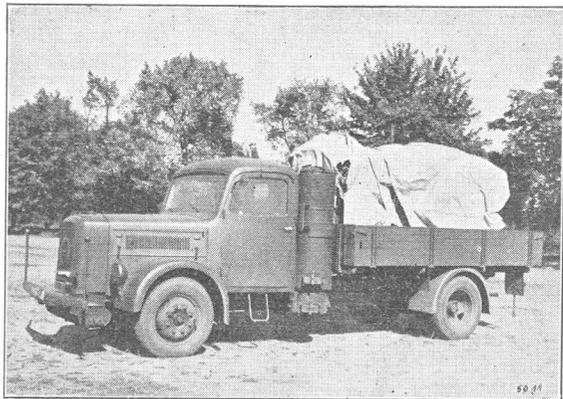
Bild 35: Deutz-AK-Fahrzeuggeneratoranlage im LKW.
