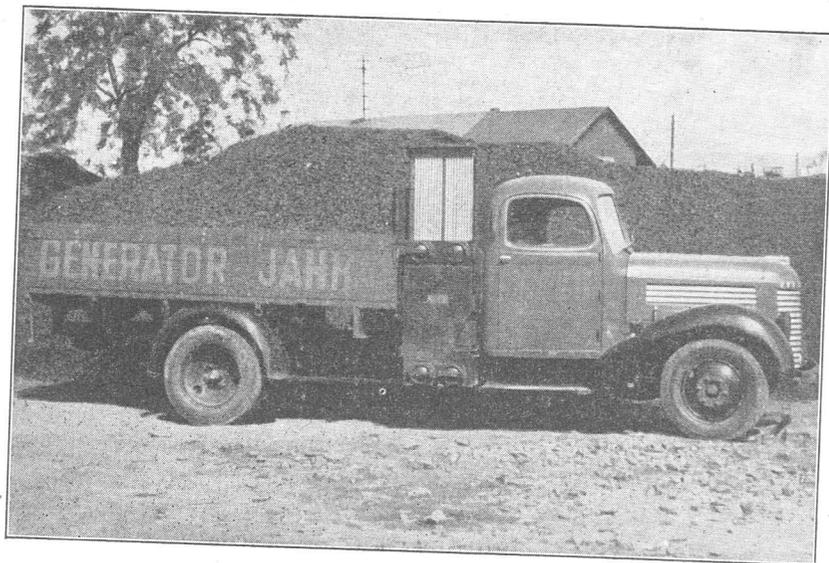
Bild 25: Grunert-HB-Fahrzeuggeneratoranlage im LKW.
