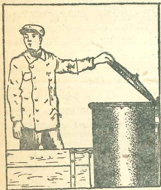
Фиг. 120. Рекомендуемое положение рабочего при открывании крышки загрузочного люка бункера.
