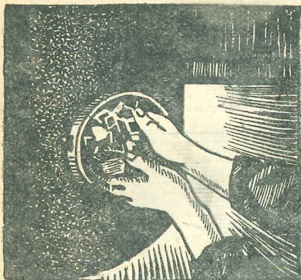
Фиг. 74. Заполнение углем дополнительной восстановительной зоны.
