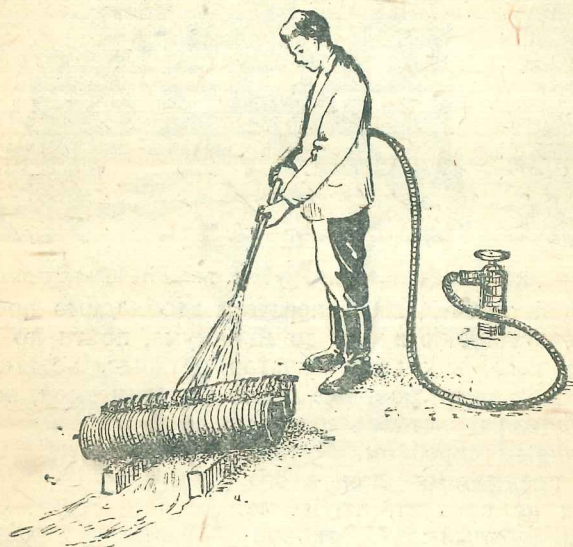
Фиг. 95. Промывка секций пластин при помощи брандспойта.
