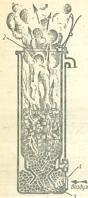
Фиг. 84. Схема розжига газогенератора самотягой:
