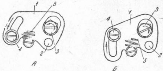
Рис. 22. Схема приспособления для натяжения пружинки реле-регулятора РРА-44:
