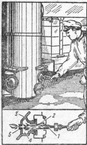
Рис. 5. Розжиг газогенератора факелом (внизу показано подсасывание языков пламени в топливник при розжиге):
