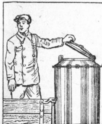
Рис. 24. Рекомендуемое положение рабочего при открывании крышки загрузочного люка бункера.
