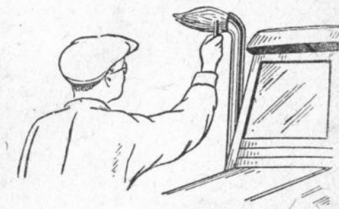
Рис. 6. Проба готовности газа поджиганием его струи.
