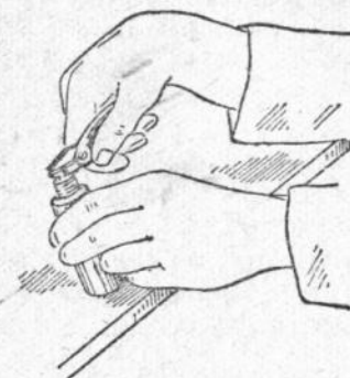
Рис. 16. Регулировка боковых электродов запальной свечи.
