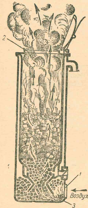
Рис. 19. Схема розжига газогенератора самотягой:
