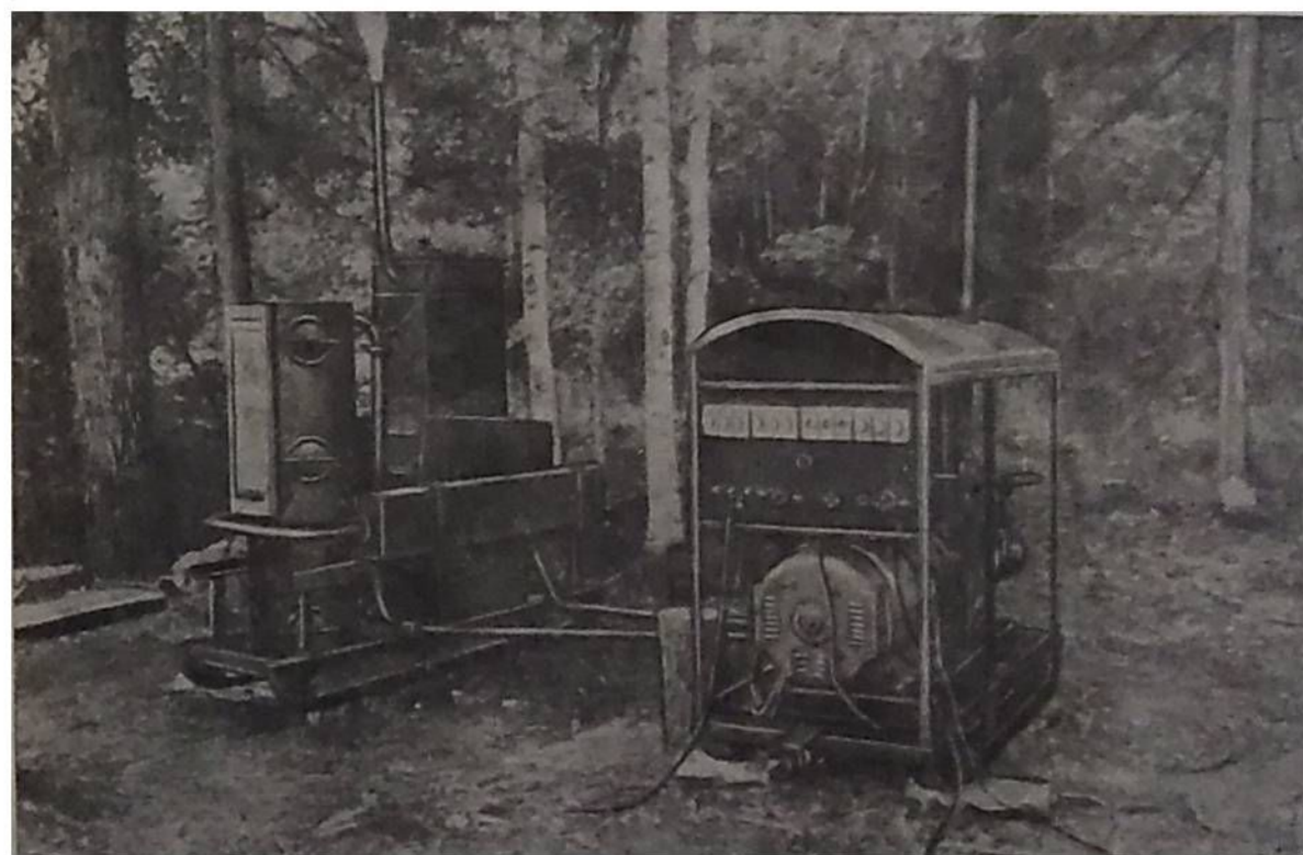
Рис. 4. Общий вид передвижной электростанции ПЭСГ-12-200 с газогенераторной установкой ЦНИИМЭ-18
