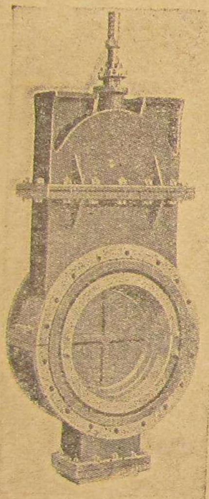
Фиг. 70. Проходная газовая задвижка Лудло со шпинделем.
