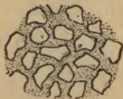
Фиг. 189. Расположение песчинок в глиняном растворе (в сильно увеличенном виде).
