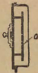
Фиг. 93. Топочные дверцы с внутренним предохранительным полотном.
