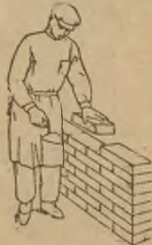
Фиг. 203. Приемы подливания известкового и цементного растворов.
