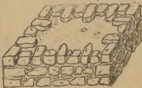
Фиг. 202. Кладка фундамента из бутового камня.
