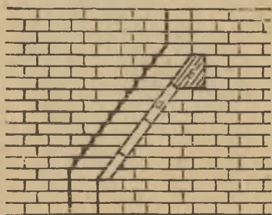
Фиг. 120. Наклонный канал в стене (уводка).
