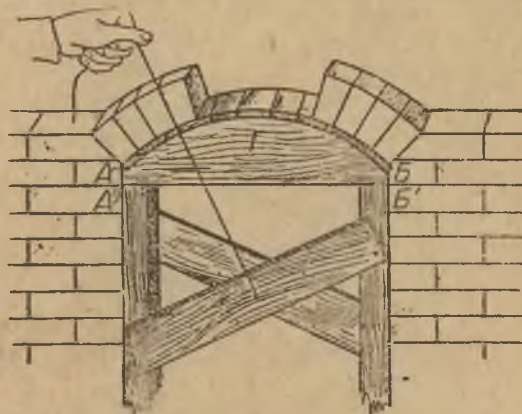
Фиг. 214. Проверка правильности направления швов арки с помощью шнура.
