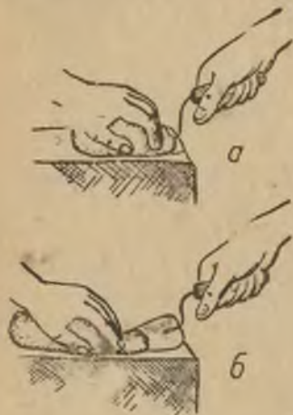
Фиг. 197. Рационализованный прием растилания раствора.
