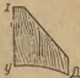
Фиг. 215. Шаблон для проверки направления швов свода.
