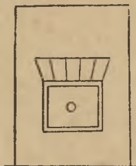
Фиг. 207. Перемычка над топочными дверцами.
