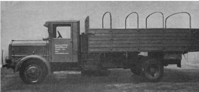
Abb. 40. Hansa-Universalgaserzeuger im Fahrzeug.
