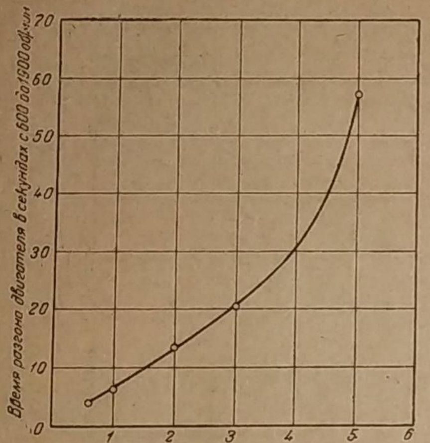
Фиг. 287. Характеристика приёмности двигателя при работе на газогенераторной установке «Панар-Левассор».
