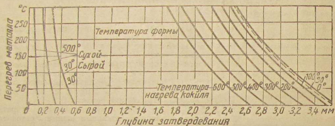
Фиг. 1. Глубина затвердевания чугуна в первую секунду после заливки при литье в песчаную и металлическую формы:
