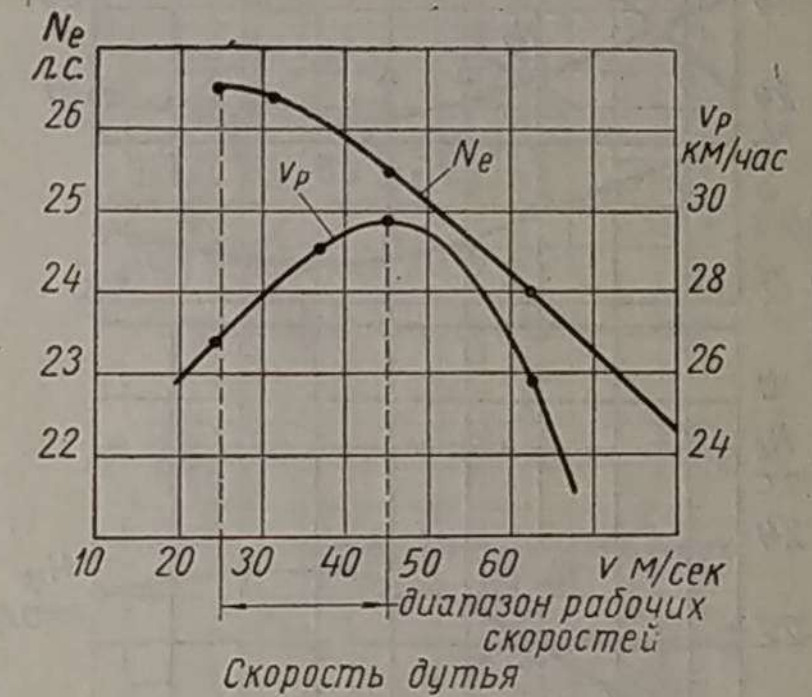
Фиг. 11. Влияние скорости дутья (поступления воздуха в камеру газификации) на мощность двигателя и приемистость автомобиля при работе газогенератора поперечного процесса газификации на древесном угле ( v_p — средняя скорость при разгоне на участке длиной 1 км).
