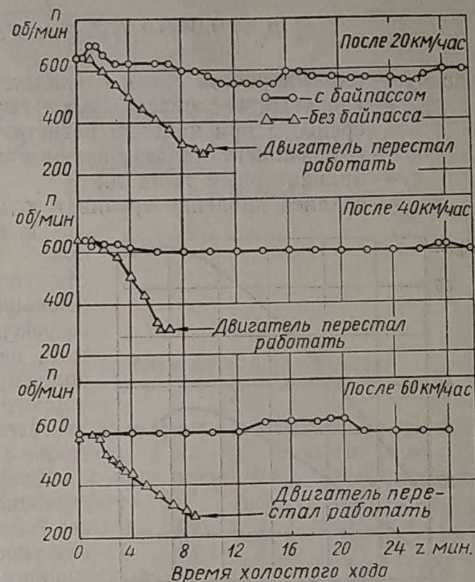
Фиг. 101. Изменение числа оборотов холостого хода двигателя ГАЗ-42 при работе с байпасом и без него на генераторном газе из древесных чурок:
