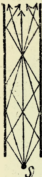
Рис. 66. Распространение звука в трубе.
