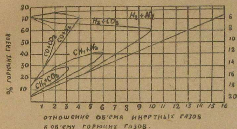
Рис. 1. Границы взрываемости основных составных частей промышленных газов в зависимости от содержания балласта.
