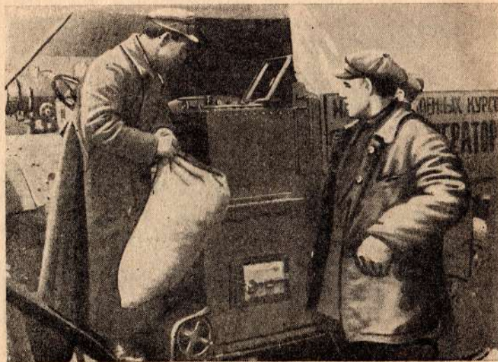
Иван Степанович загружает уголь в шахту газогенератора перед отправлением машины в пробег.
