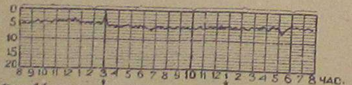
фиг. 14. Содержание CO_2 в генерат. газе после установки автоматическ. аппарата для определения CO_2 .
