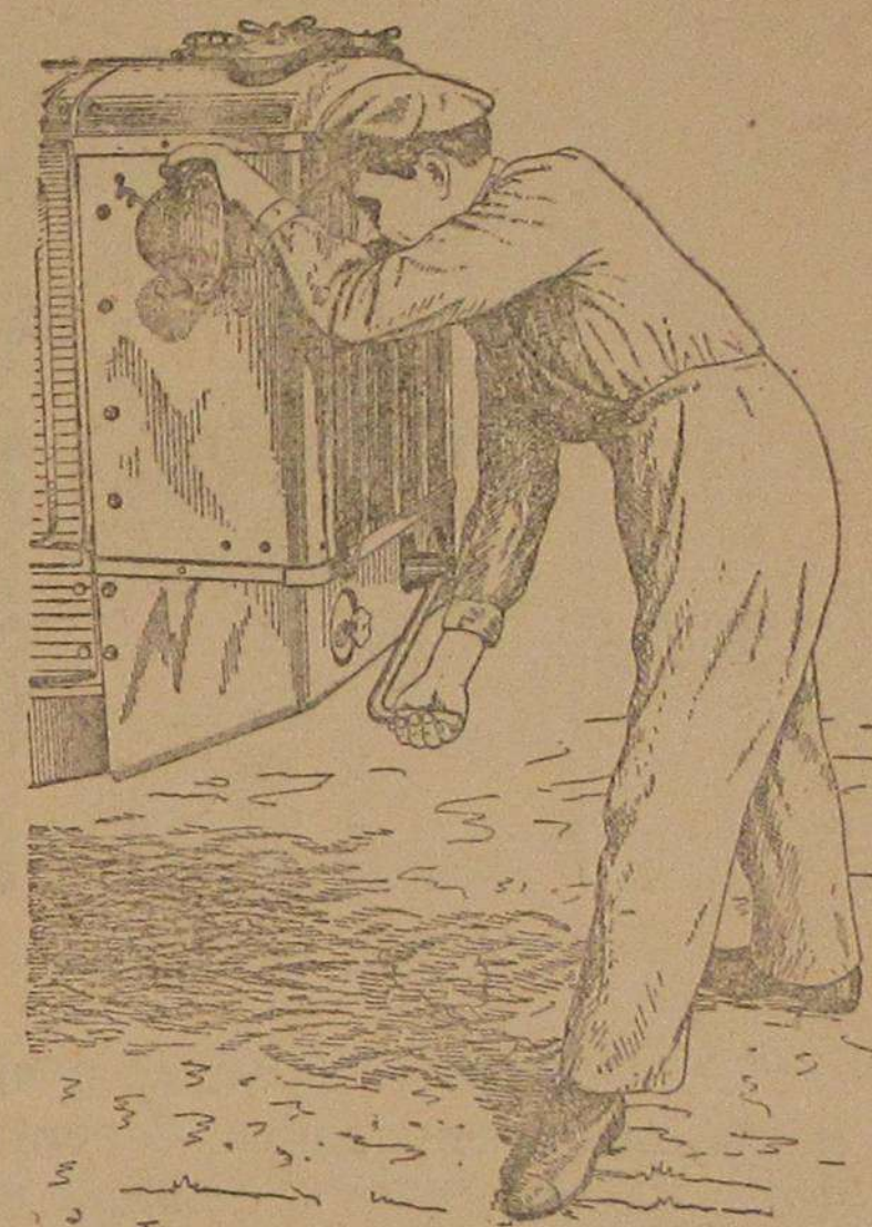
Рис. 45. Правильный обхват пусковой рукоятки (большой палец прижат к ладони).
