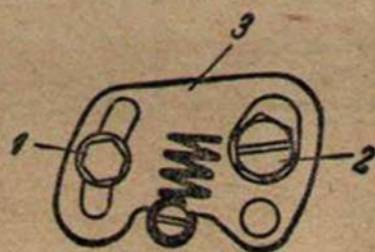
Рис. 4. Схема устройства для натяжения пружины реле-регулятора.
