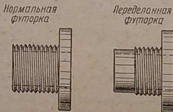
Рис. 11. Укорачивание резьбы футорки.
