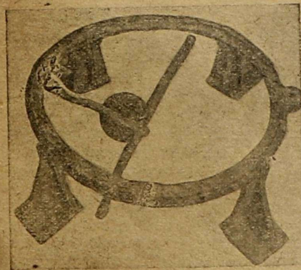
Рис. 15. Прогорание опоры колосниковой решетки
