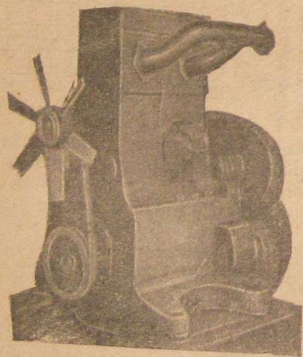
Фиг. 50. Двухцилиндровый комбинированный двигатель Оренштейн и Коппель, приспособленный для работы на газе.
