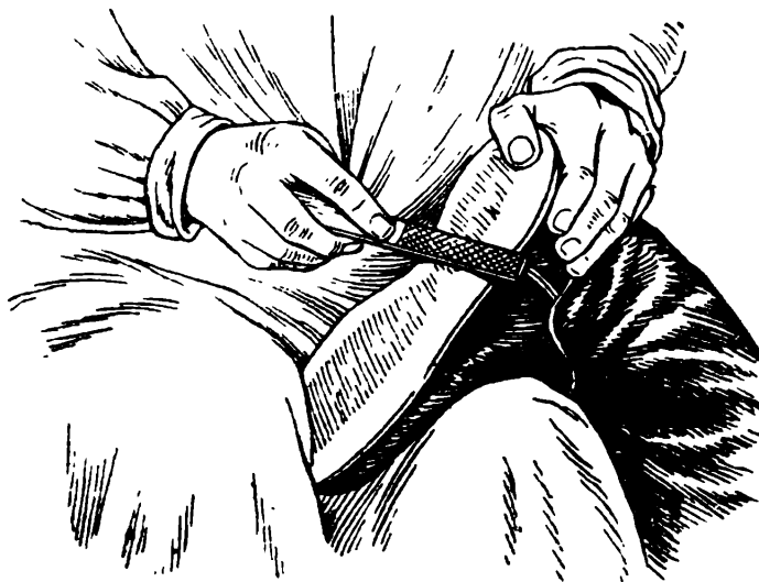
Рис. 116. Подчистка шпилек рашпилем
