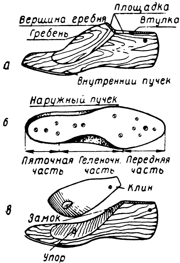
Рис. 31. Колодка для глухой затяжки с выпиленным клином: а — вид с внутренней стороны, б — вид со стороны следа, в — вид колодки со снятым клином
