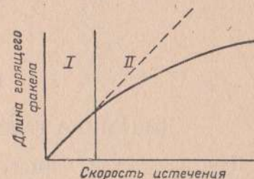
Фиг. 3. Зависимость длины горящего факела от скорости истечения газа в условиях свободной струи.
