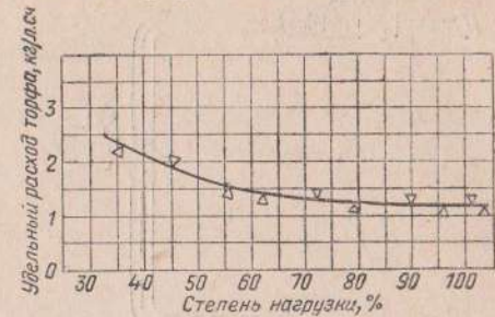
Фиг. 3. Удельный расход торфа для газогенератора УТГ-4-90.
