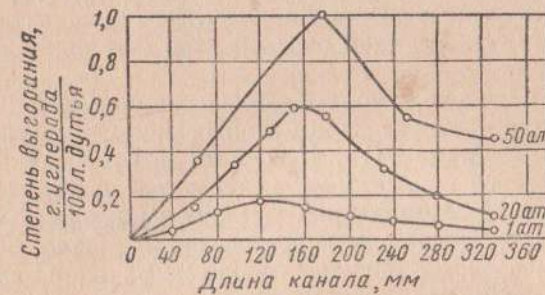
Фиг. 4. Выгорание угля по длине угольного канала при разных давлениях (воздушное дутье).
