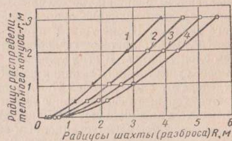
Фиг. 5. Зависимость радиуса распределительного конуса от радиуса шахты при различной высоте свободного объема.
