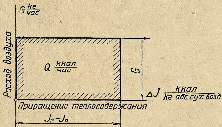
Фиг. 11. Графическая связь количеств тепла, воздуха и приращения его теплосодержания.
