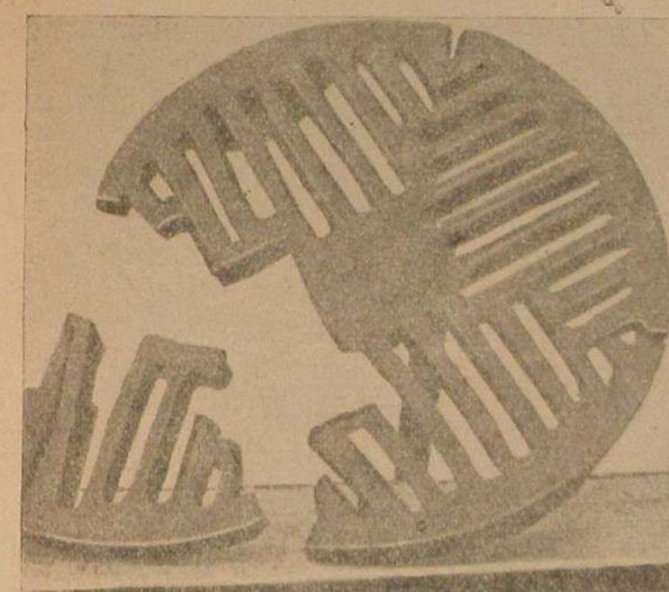
Рис. 6. Разрушение центральной решетки.
