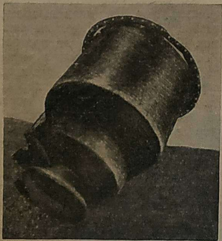
Рис. 1. Бункер газогенераторной установки ЛС-1-3 с оборванным соединительным фланцем
